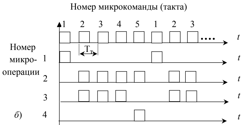
Рис.12.5. Структурная схема (а) и диаграммы управляющих сигналов (б) НФ с сигнальной памятью на ОЗУ
