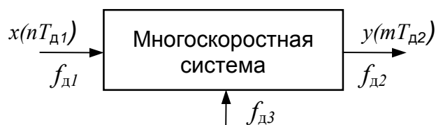
Рис. 10.1. Общая структура многоскоростной системы ЦОС
